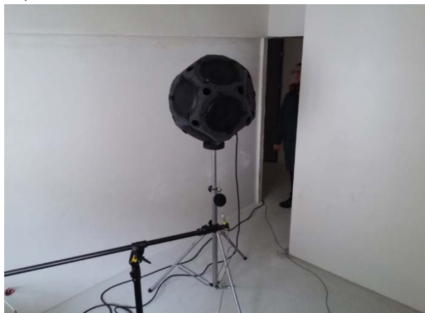
Fot. 3. Widok pomieszczeń w trakcie realizacji terenowych pomiarów izolacyjności od dźwięków powietrznych:
