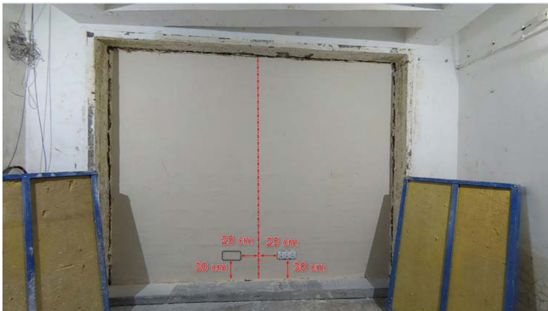
Fot. 4. Widok ściany zmodyfikowanej poprzez zamontowanie gniazd elektrycznych (widoczne gniazda elektryczne szt. 3) – widok od strony komory odbiorczej. Laboratorium Akustyki Wydziału Budownictwa Politechniki Śląskiej [41]
