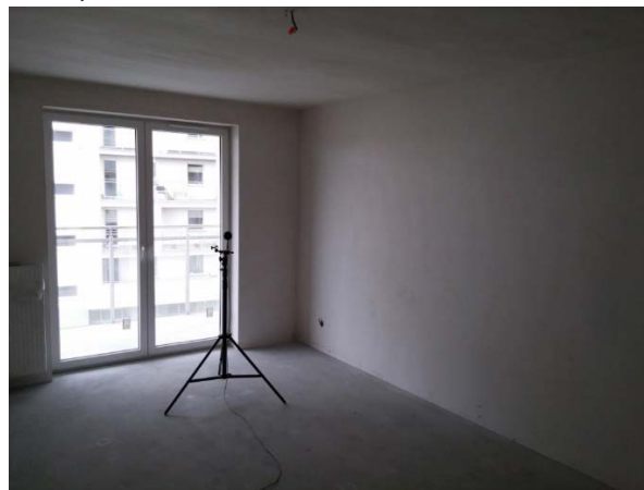
Fot. 3. Widok pomieszczeń w trakcie realizacji terenowych pomiarów izolacyjności od dźwięków powietrznych:
